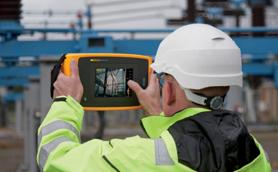
ii910 Hassas Akustik Görüntüleme Cihazı ile çekilen görüntüde, yüksek gerilimli bir uygulamada kısmi deşarjın algılanması yer almaktadır.
