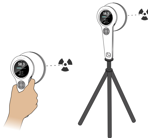
Abbildung 3. Mit der Sensorfläche in Richtung der Strahlenquelle positionieren.
