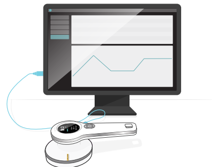
Figura 10. Collegamento dello strumento a RaySafe View.
