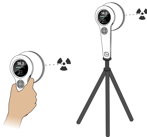
图 3. 将传感器区域对着辐射源。
