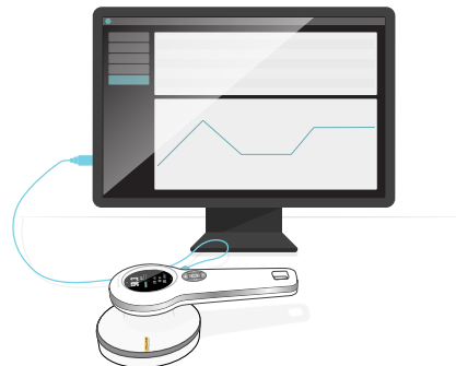
图 10. 将仪器连接到 RaySafe View。
